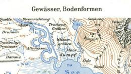
Die schwächeren und ausgeprägten braunen Farben bedeuten 20m, die stärkeren 100m Höhenlinien, die lang und kurz gestrichelten Zwischenlinien haben Höhenabstände von 50m.
